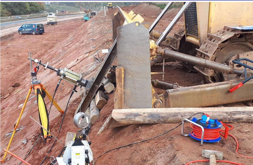
Ankerkraftmessung zur Hangabsicherung im Straßenbau: Die Setzung eines Bodenankers soll gemessen werden. Dazu wird auf den eingebrachten Bodenanker eine Kraft von ca. 600kN mittels Hydraulikzylinder aufgebracht und der Bodenanker minimal herausgezogen. Der Weg wird mit einer Messuhr (auf dem Stativ montiert) gemessen.
