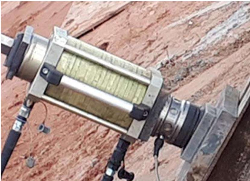
Die Kraftmessung erfolgt mit einem 800kN Kraftmessring (Mietgerät). Das Axialgelenklager AX 50 gleicht die sichtbare Parallelitätsabweichung zwischen Grundplatte und Kraftmessring gut aus
