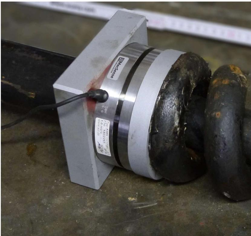
Kraftüberwachung eines Schleusenbetriebes:
