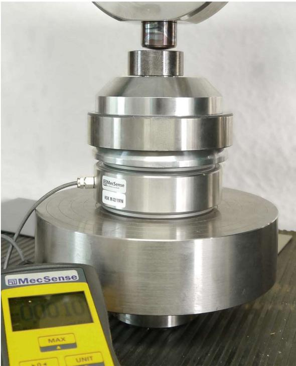
Foto: Kraftmessring KSK beim Kalibrieren
