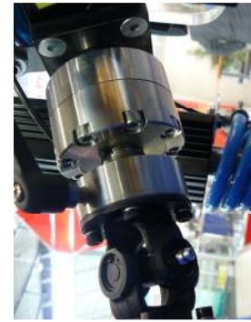
Foto: KAF-S mit Gegenplatte in einem Möbelprüfstand
